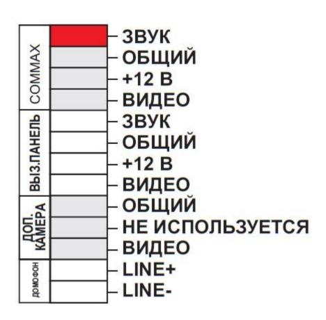
Цоколёвка соединительного разъёма
